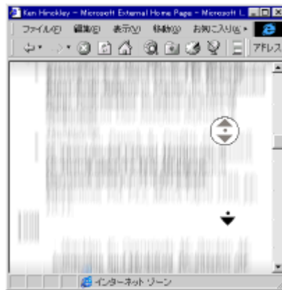
図 1: 速度制御によるスクロールの問題点。移動速度が速すぎると、表示に目が追いつかなくなって制御不能となる。
