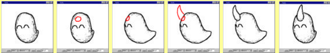
k)初期状態 l)入力ストローク 1 m)回転した所 n)入力ストローク 2 o)突起生成結果 p)回転した所
